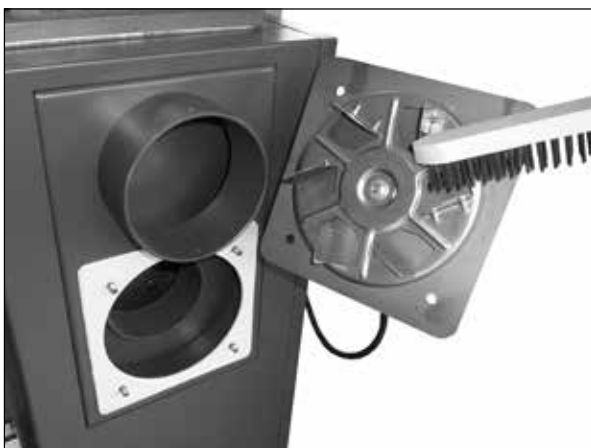
Die Reinigung des Umlauftrad und die Kontrolle des Schaufels bei Saugzugventilator
