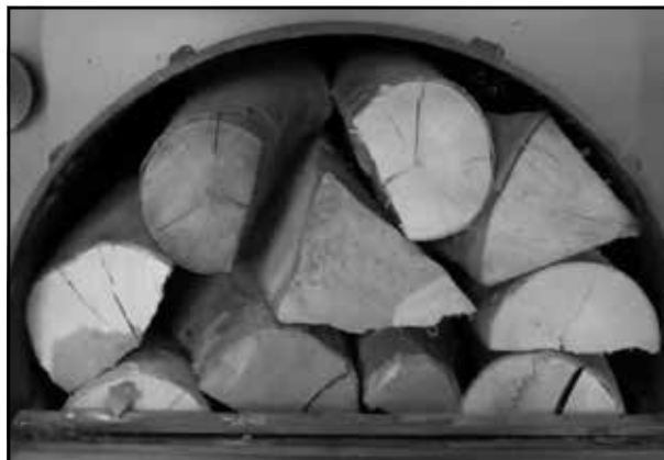
Die richtig befüllte Kammer im Detail
