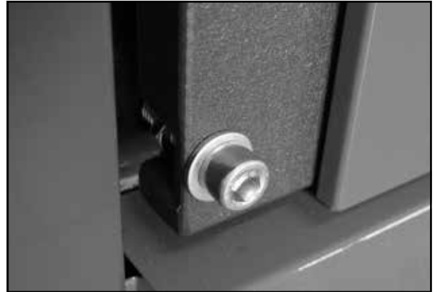
Die Sicherungsschraube der Nachlegetür angezogen
