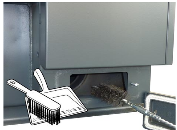
Vorführung der Reinigung des Rauchkanals mit Drahtbürste.
